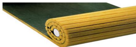
Sistemi isolanti in rotoli costituiti da doghe di vari materiali isolanti (polistirene estruso ed espanso, poliuretano, lana di vetro e lana di roccia), accoppiati a membrane bitume-polimero armate con velo di vetro o tessuto non tessuto di poliestere. Alcune versioni sono disponibili anche in pannelli piani. Opportune cimose permettono di sigillare in modo facile e veloce i giunti.
