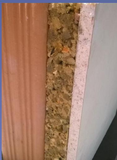
PLASTIGIPS PUR viene usata per l'isolamento acustico delle pareti esistenti con applicazione in controparete; parete divisoria a secco con struttura metallica; controsoffitto con struttura metallica. Per un migliore risultato acustico viene consigliato l'impiego della lastra racchiuso da una lastra di gesso rivestito applicata a giunti sfalsati.
